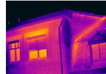
Corniche et ouvertures : déperdition de chaleur et d'énergie
